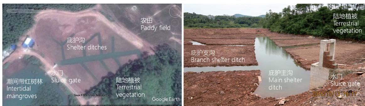
图2 纳潮生态混养塘的庇护沟构建
