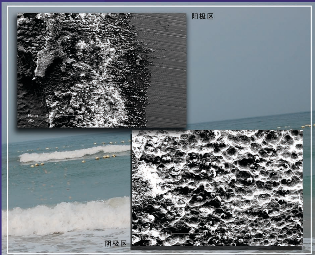
X65 管线钢水线腐蚀阳极区和阴极区腐蚀产物形貌 (图片由本期作者刘猛提供)
