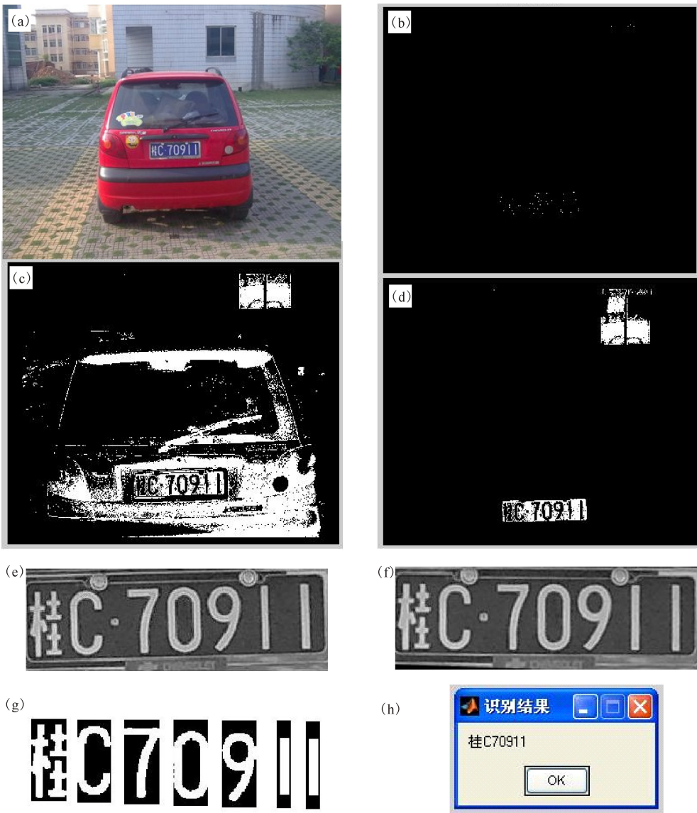
图6 基于阈值分割和区域生长的车牌识别过程
