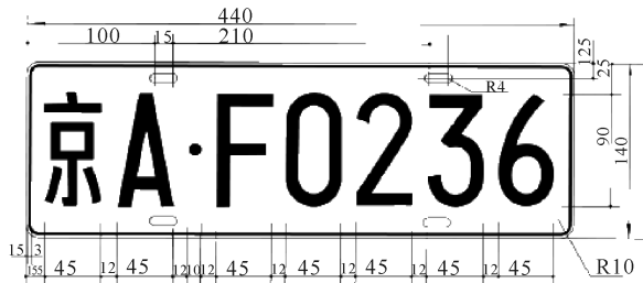
图3 我国车牌规格(mm)
