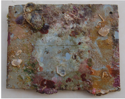
图9 南海三亚试验站年板污损生物示意图
