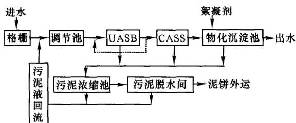
图 1 污水及污泥处理工艺流程
