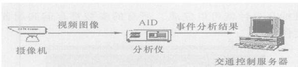
图 1 系统硬件构成
