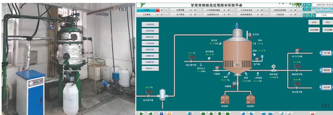
(a) 实验平台硬件, (b) 实验平台监控系统界面
