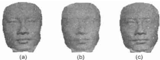
图 8 人脸模型的原始网格、基网格和法向网格
