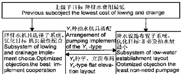
图 6 降排水设计子系统组合
