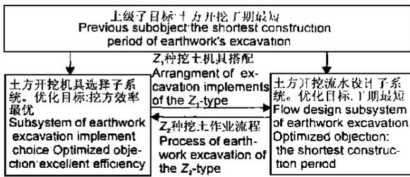
图 7 土方开挖设计子系统组合
