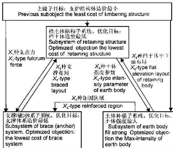
图 5 支护结构体系子系统组合
