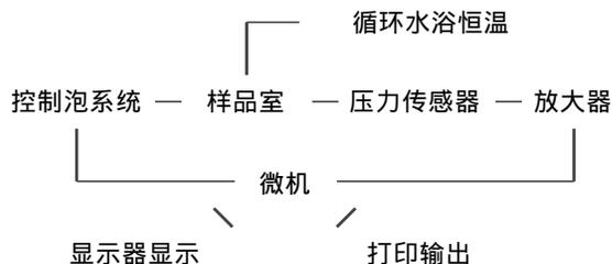
图 2 测量系统结构图
